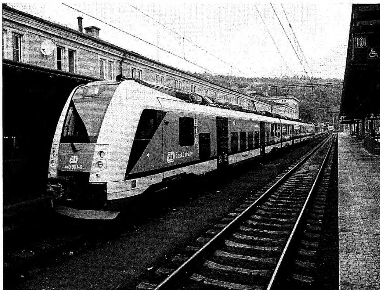
Рис. 113. Пригородный поезд Škoda RegioPanter с пониженным уровнем пола для линий с низкими платформами
