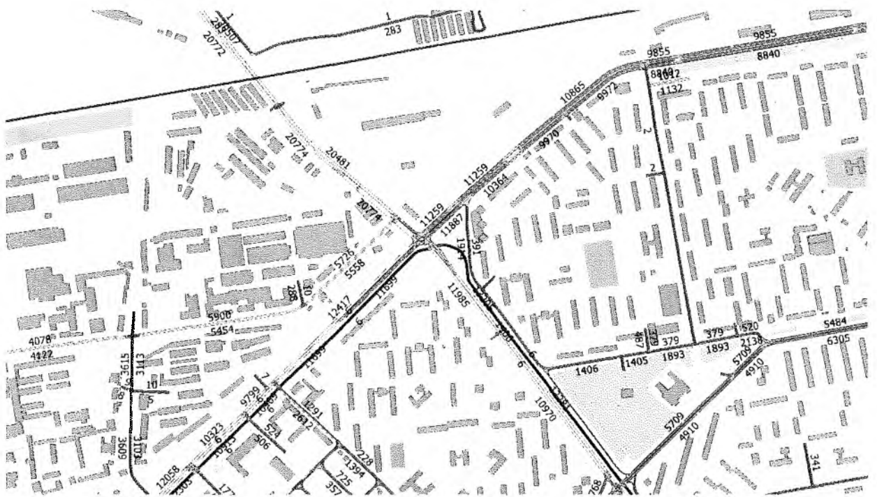
Рис. 70. Интенсивность движения на развязке у Трубного завода. Существующее положение
