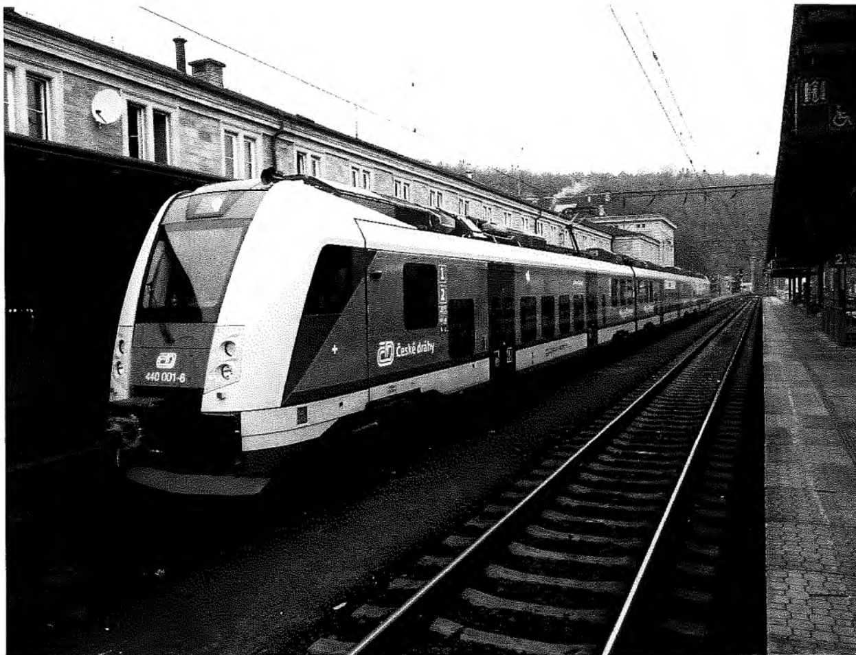
Рис. 96. Пригородный поезд Škoda RegioPanter с пониженным уровнем пола для линий с низкими платформами
