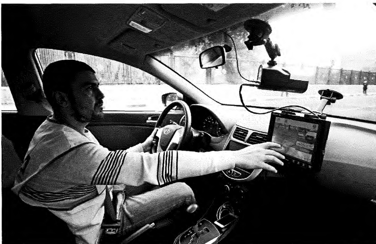
Рис. 101. Оборудование автомобиля «паркон»: камера и компьютер для распознавания регистрационных знаков
