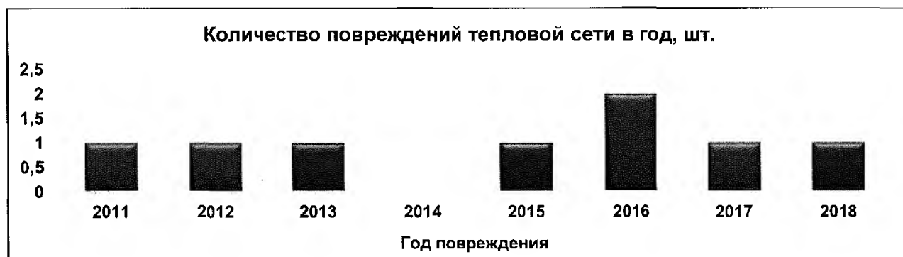
Рисунок 2.6. График изменения количества повреждений тепловых сетей котельной ООО «Фирма «Тройка-Л», находящихся на обслуживании АО «ЛГЭК», за неотапительные периоды 2010-2018 гг.
