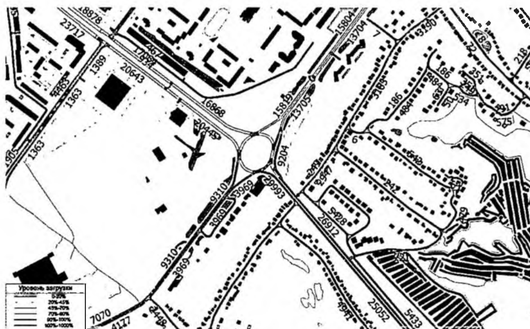
Рис. 40. Краткосрочный прогноз загрузки узла «Площадь Танкистов» (инерционный сценарий)
